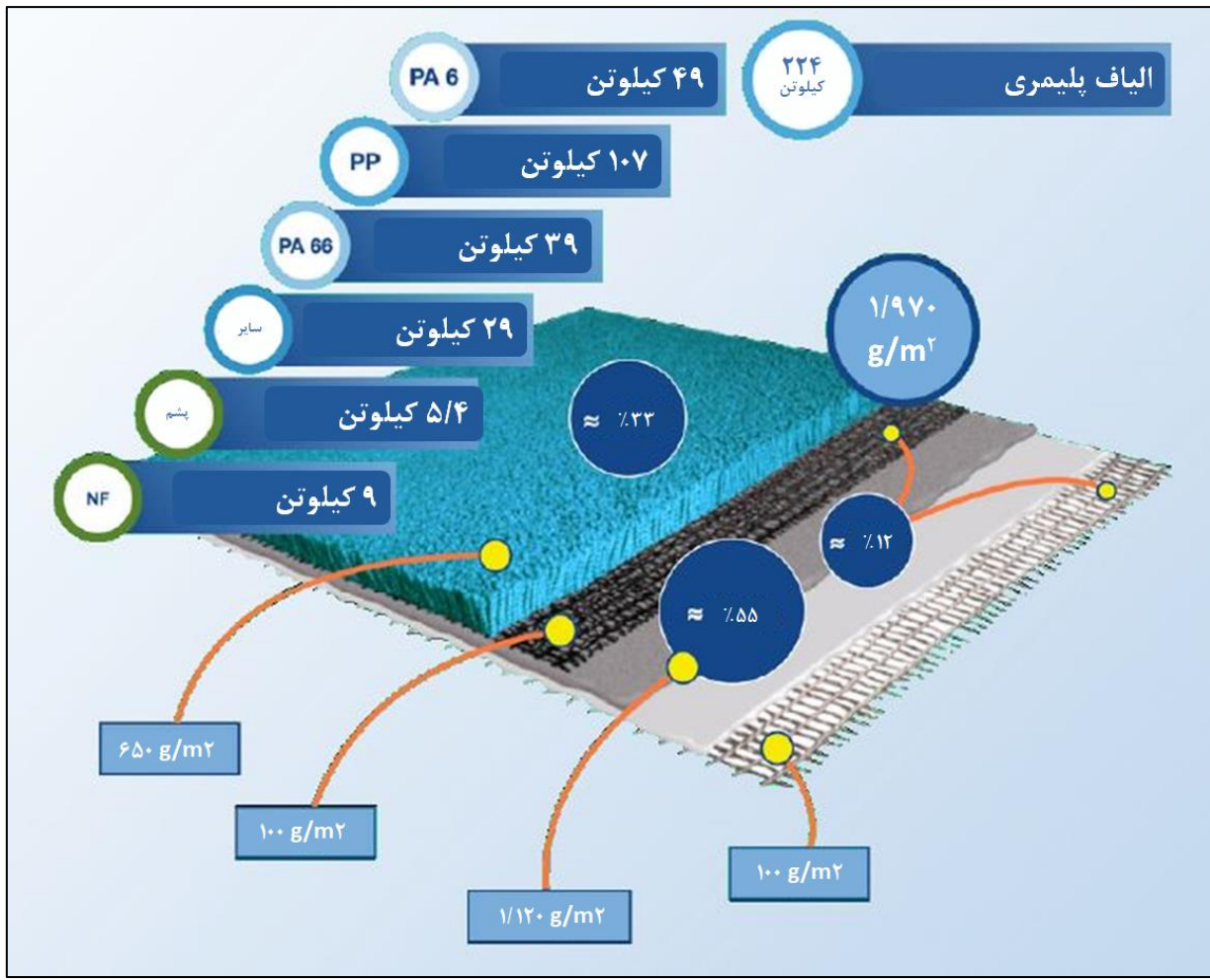
شکل ۱۶- متوسط ترکیب فرش تافتینگ فروخته شده در اتحادیه اروپا بر اساس داده‌های سال ۲۰۱۸ و حجم کل الیاف نهایی
